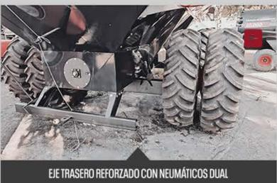
EJE TRASERO REFORZADO CON NEUMÁTICOS DUAL
